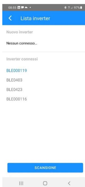
3. In automatico se tramite scansione o manualmente scegliendolo dall'elenco inverter partirà la connessione all'inverter tramite Bluetooth e poi si aprirà la schermata "HOME"
