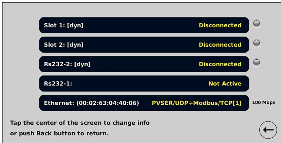
En este ejemplo vemos una conexión PVSER/UDP y Modbus TCP en el puerto Ethernet y una conexión a una medida externa en el puerto serie nº2, que en este caso son las medidas de corriente del DC-BOX.
