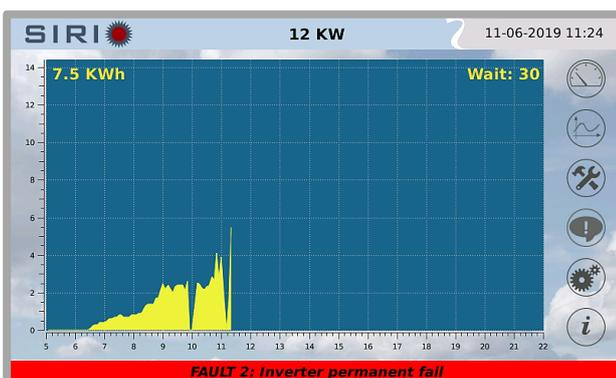
**ALARMA PERMANENTE:** La barra de estado se convierte en "ROJO" indica una condición de alarma que no puede restablecerse: es necesario realizar una intervención para restablecer el funcionamiento. En la parte inferior de la pantalla se encuentran una serie de mensajes que explican la tipología de alarma. Ver la sección siguiente para la explicación de los mismos.
