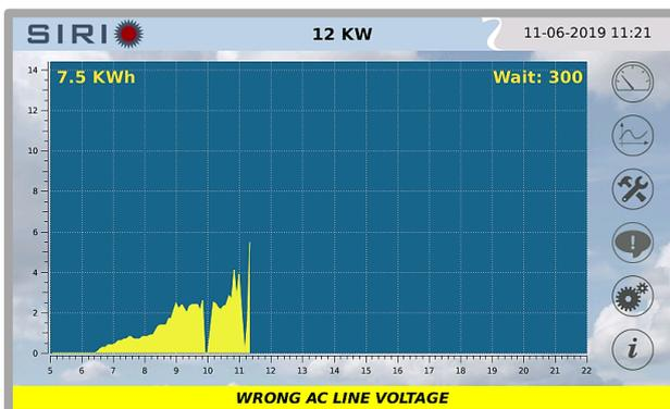
**ALARMAS:** La barra de estado se convierte en "AMARILLO" significa que las condiciones de irradiación son buenas, pero el inverter no parte a causa de problemas temporales como por ejemplo una tensión inadecuada de la red, exceso de temperatura del inverter, etc. En la parte inferior de la pantalla se encuentran una serie de mensajes que explican el tipo de alarma. Ver la sección siguiente para la explicación de los mismos.
